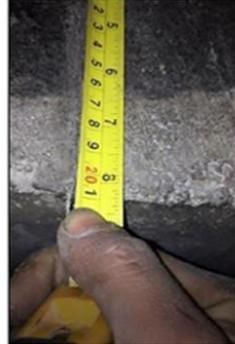
Fotografía 17: Espesores menores a los de diseño Tramo 1 (4+427 A 4+499) (11-12-2018)
