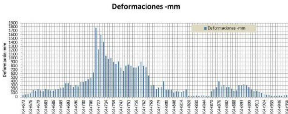
Ilustración 8: Registro de deformaciones máximas hasta el 2016 en zona de influencia de la falla La Soledad del túnel Principal
